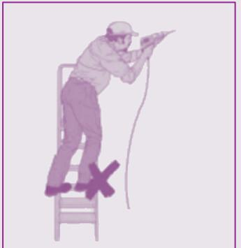
Работать с использованием электрического и пневматического инструмента, строительно-монтажных пистолетов
