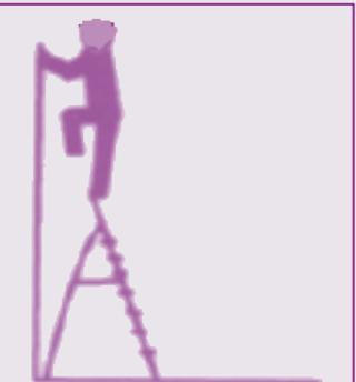
Подниматься на предохранительный упор стремянки
